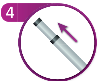
Rozłóż pozostałe segmenty masztu
